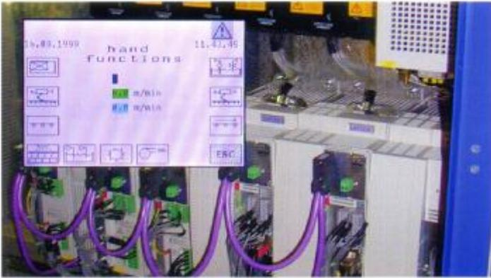
**SPS-Steuerung, Siemens S7, wahlweise mit Visualisierung oder Touchscreen, integrierte Anpressdruckregelung der Bürstwalzen, optionale Plattendickenregelung und -messung, Kompen-sation des Bürstwalzenverschleißes, Sonderfunk-tionen „foot-print“- und „Bürstabrichten“.**
